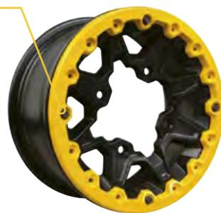
**NOTE:** Écrous - 250100100 / Capuchon couvre-moyeu 705400928**VERROU DE TALON DE 14 PO**
