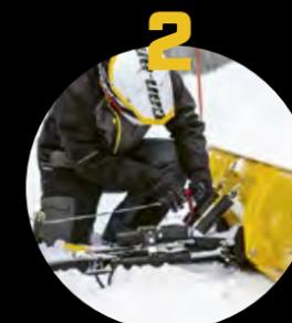
2 Attachez le câble de treuil à la pelle à l'aide du crochet de guidage/guide-câble.
