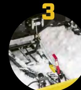
3 Levez la pelle jusqu'à ce qu'elle s'attache à la plaque de fixation.
