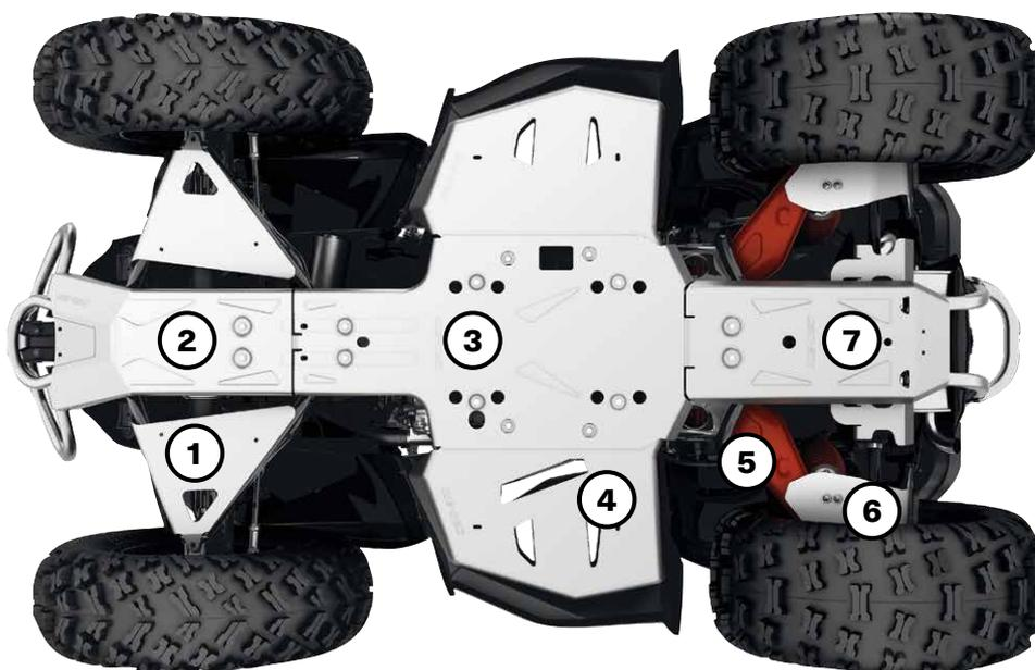
Pour une durabilité et une résistance absolues, toutes nos plaques de protection en aluminium sont en aluminium 5052 H32 haute résistance de 4,5 mm d'épaisseur.
